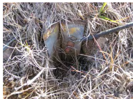
Mynd 32. Ófullnægjandi frágangur jarðskauts á rafgirðingum er ein algengasta ástæða þess að þær eru ekki búfjárheldar. Myndin sýnir of lítið jarðskaut við langa girðingu auk þess sem tengingar eru ryðgaðar. (Mynd: Grétar Einarsson)
