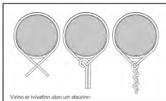
Mynd 13. Mjög mikilvægt er að hnýting á horn- og aflstaura í rafgirðingum sé rétt útfærð. (Mynd: Víðir Ragnarsson)
