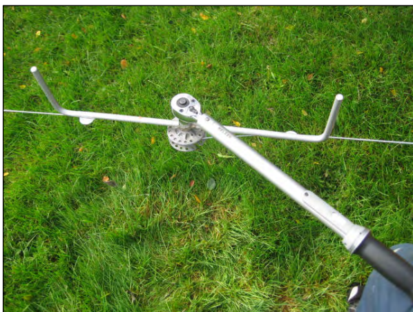
Mynd 11. Átaksmælingar við strekkingu girðingavíra. (Ljósmynd: Grétar Einarsson)
